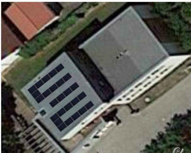
Navrhované uspořádání 29ks panelů (dispoziční řešení) na střeše budovy
